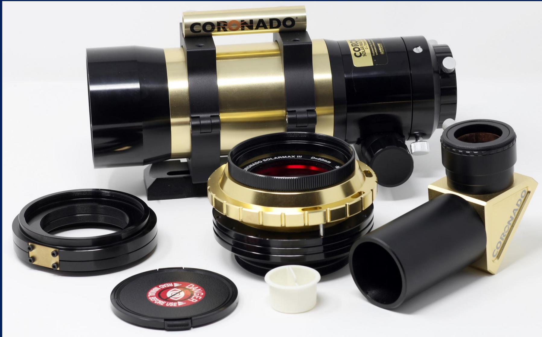
Solarmax double stack T3 de 60 mm et BF 15 sur lunette Coronado de 70 mm
